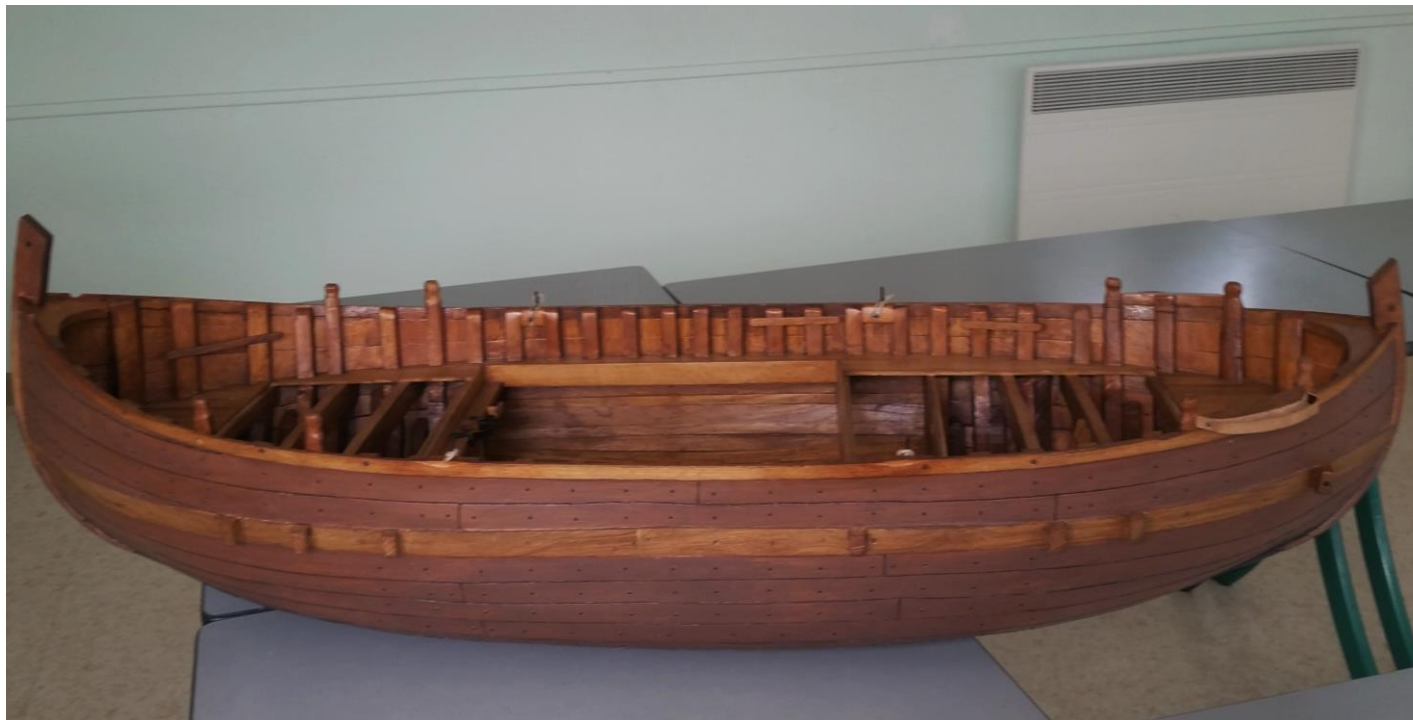
Finition de la pose des clous à l'intérieur de la cale Pose des clous extérieurs sur le bordé Avril - Mai 2023
