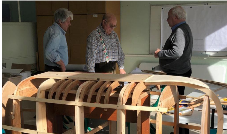
Réalisation de la proto-membrure première 1/2 Septembre à Décembre 2021
