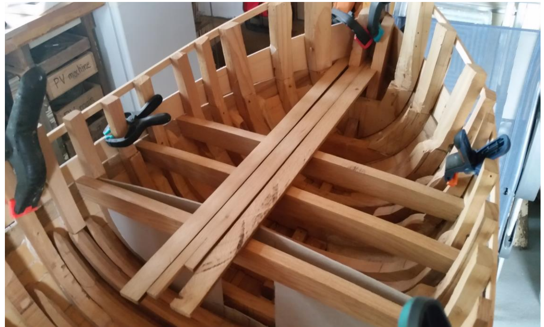
Pose des baux, pavois, vaigrage, cloisons et ponts 1/2 Octobre à Décembre 2022
