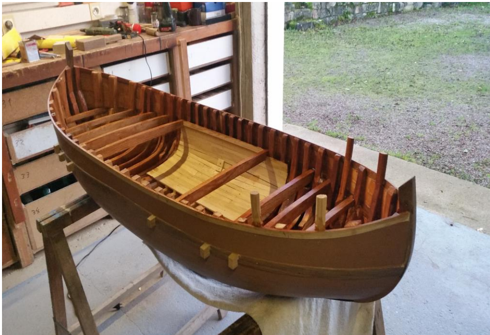
Pose des baux, pavois, vaigrage, cloisons et ponts 1/2 Octobre à Décembre 2022
