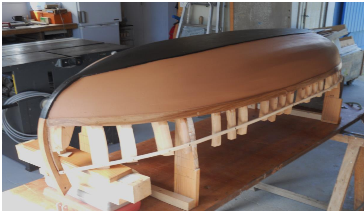
Pose et finition du bordé 2/2 Juillet à Septembre 2022
