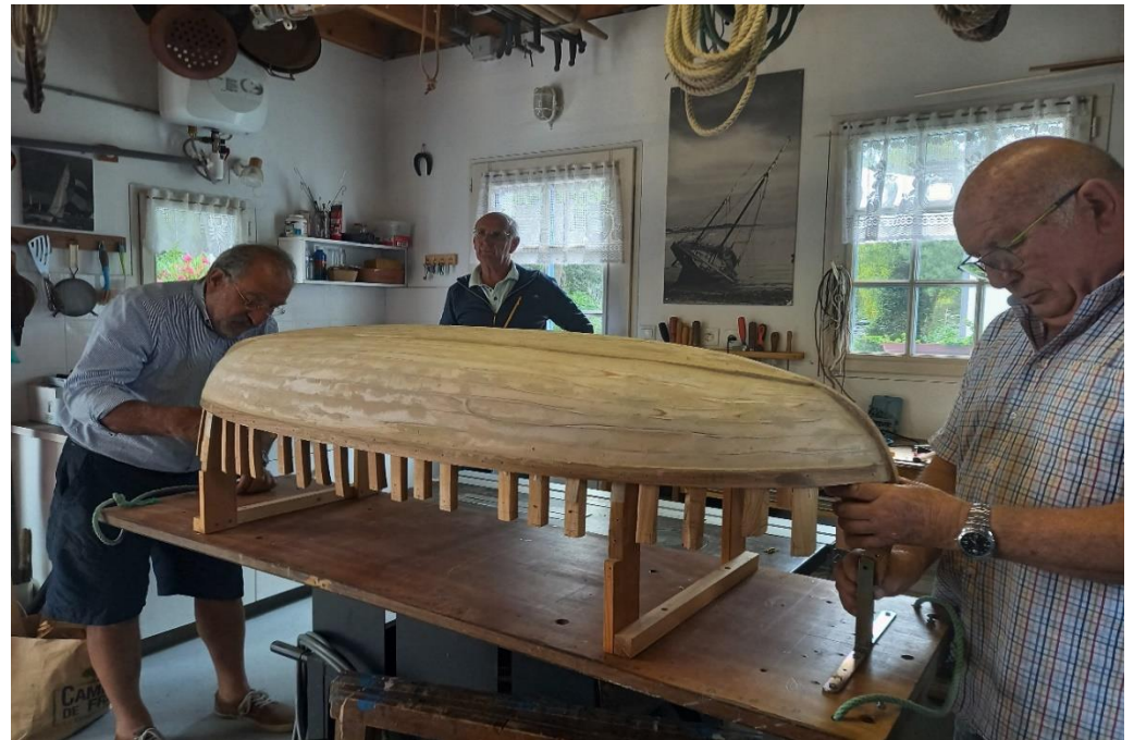
Pose et finition du bordé 1/2 Juillet à Septembre 2022
