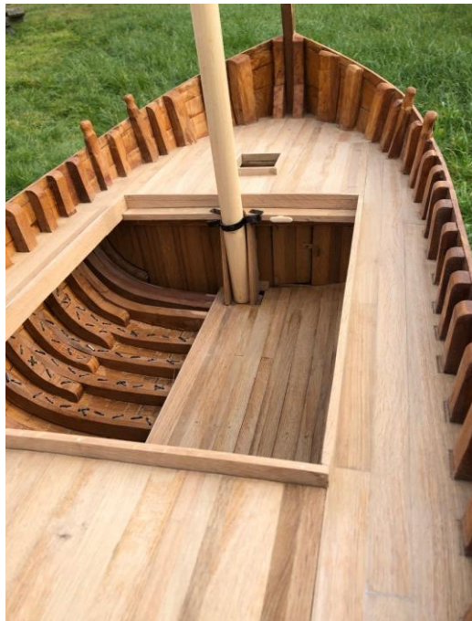
Finition du pont et du gréement, pose des clous intérieur de la cale Janvier à Février 2023
